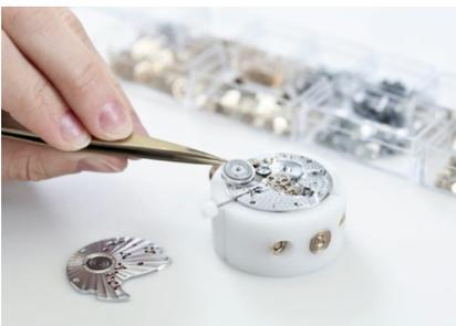
7. In Lambda arbeitet DUW 1001, DUW für Deutsche Uhrenwerke NOMOS Glashütte; das erste Uhrwerk von NOMOS Glashütte, das diesen Namen trägt – ein großes, flaches Kaliber mit Doppelfederhaus. 29 Rubine sorgen für eine reibungslose Funktion, sechs davon sind in verschraubten, aufwendig von Hand polierten Goldchatons gelagert – gefertigt wie schon in den vergangenen 175 Jahren.
