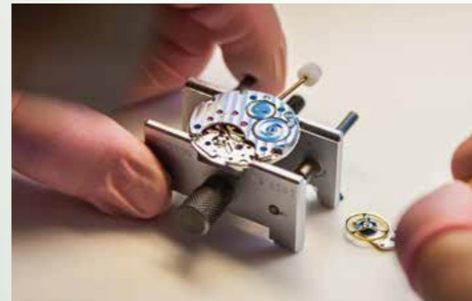
Schwung in die Bude: Das Swing-System und das Uhrwerk werden zusammengefügt.
