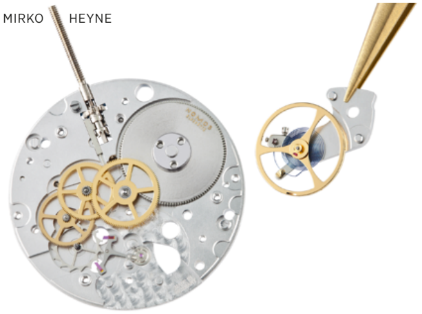
Nomos-Swing-System: an der Pinzette hängen der Unruhkloben und die Unruh mit der gebläuten Spirale.
